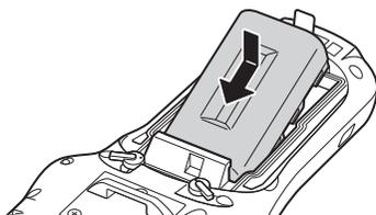
4. Вставьте обратно крышку аккумуляторной батареи в отсек как показано стрелками 1 и 2 на рисунке и переместите фиксаторы в положение «Lock».
