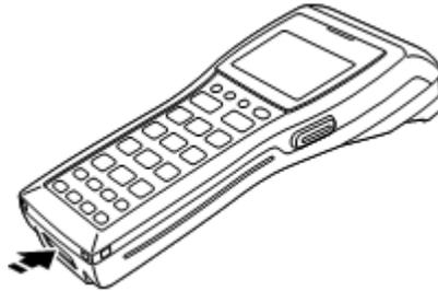
Рис.8 Расположение ИК-порта на терминале CASIO DT-930
