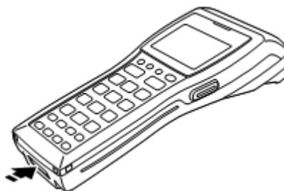
Рис.8 Расположение ИК-порта на терминале CASIO DT-930
